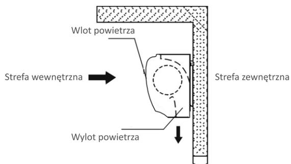
**3.3** Maksymalna wysokość montażowa od podłogi to 2,3 metry. W przypadku, gdy szerokość otworu drzwi jest większa od długości urządzenia, należy zainstalować szeregowo dwie lub większą liczbę jednostek przy zachowaniu około 20-40 mm przerw pomiędzy nimi.
