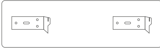
An der Wand montierte Stützen (Abb. 2)
